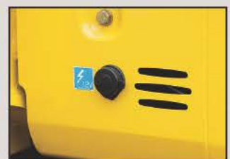
12V外部電源取出口
