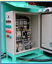
配電盤には、感電事故を防ぐ為漏電遮断機を装備、及びモーターの過負荷保護を行う熱動過電流継電器（サーマルリレー）を装備しています。また、電磁開閉器によりモーターの始動停止を行っているので停電等によりモーターが停止した時、電源が復活してもいきなり始動しないので安全です。
