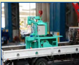
荷台の幅が1.5m以上、長さが1.9m以上あれば積載できます。本体質量は軽量（1700kgプランジャーポンプ）にできていますので2ton車でも運ぶことができます。
