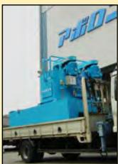
荷台の幅が2m以上、長さが3.8m以上あれば積載できます。
